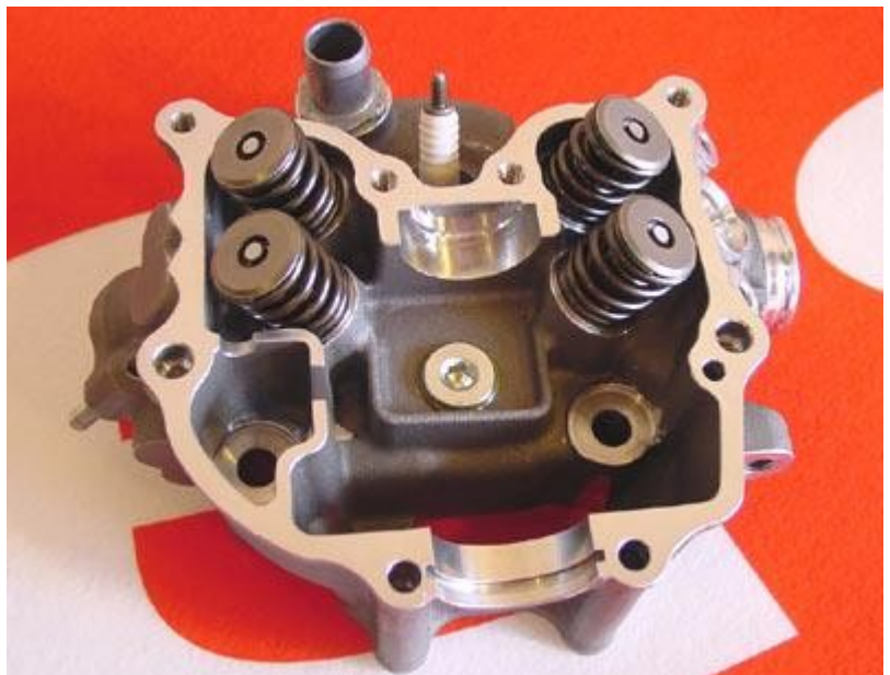
A la imatge es pot veure una culata amb les seves vàlvules.
